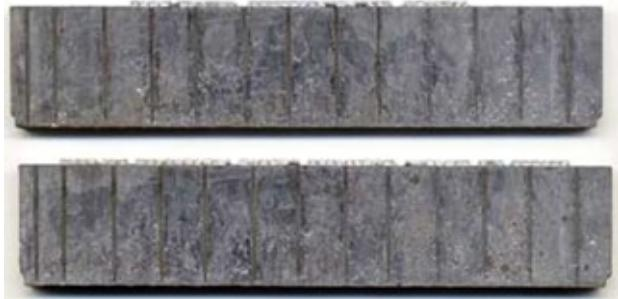
Рис. 4. Заготовки линотипа для печати текста
