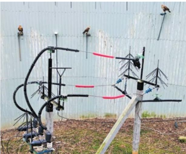
Рис. 9. Натурно-стендовые испытания новых конструкций ПЗУ в вольерных условиях
