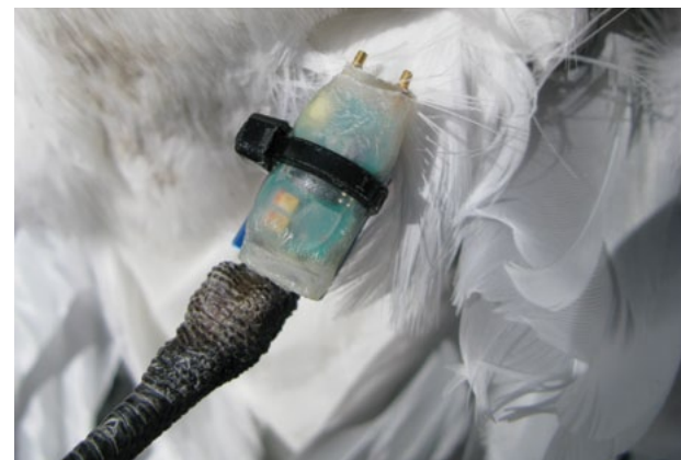
Фото 1. Логгер крепится к кольцу на ноге птицы. Антенны датчика ориентированы вверх.
